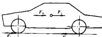
图 2-1-7 直线行驶时作用于汽车上的力
